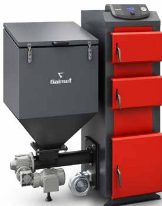
fol. 55 Kocioł c.o. Gladius KWP 25 kW z podajnikiem prostym, obrotową retortą i regulatorem TECH
